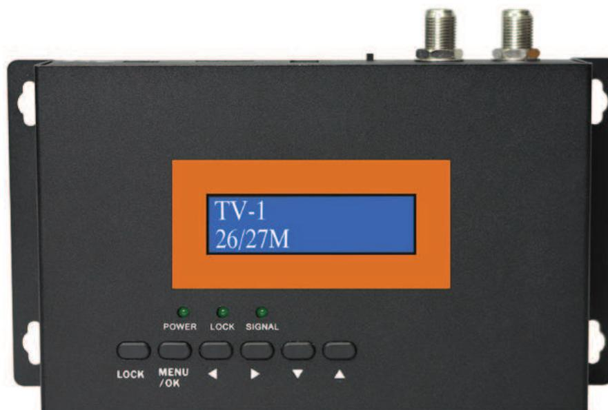
**1. LOCK: (doble utilizar el botón):** 1. El seguro el uso de los botones. cuando se pulsa 1 vez para el bloqueo "LOCK" se enciende. Para liberar el estado de bloqueo, pulse de nuevo.
